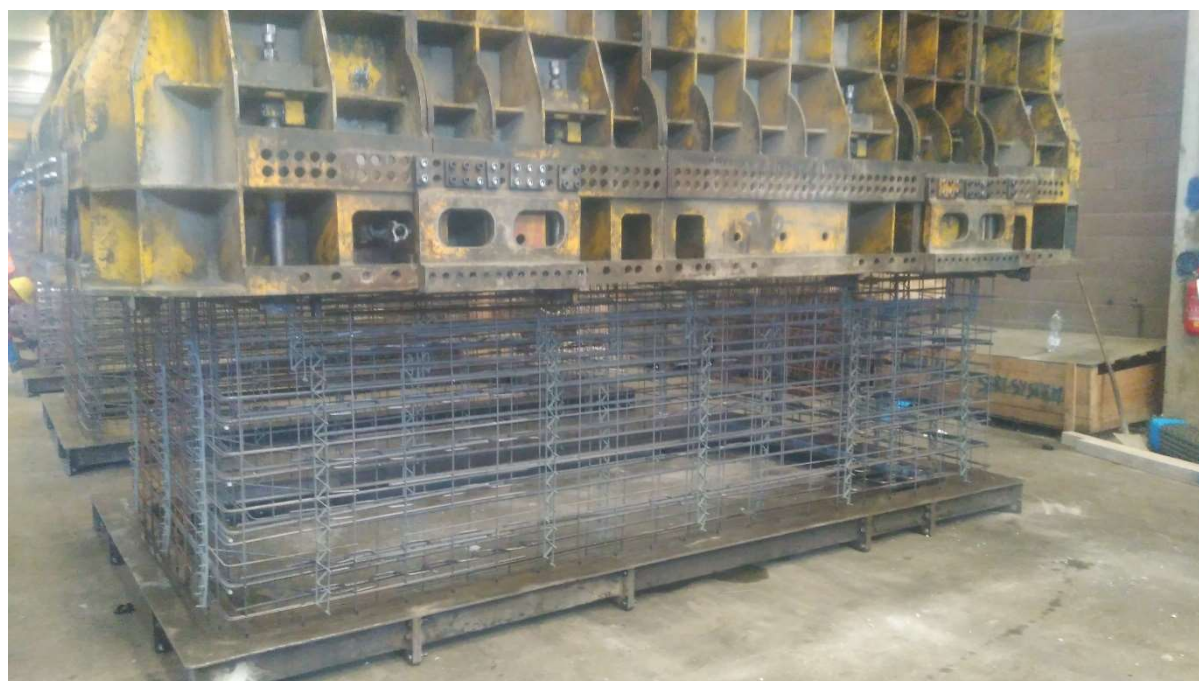
Positionnement du moule sur les armatures
